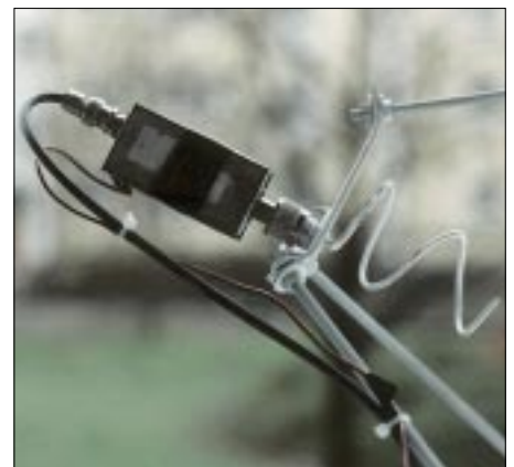
Bild 3: Helix-Erreger und Vorverstärker am Feedpunkt des 60-cm-Spiegels für 13-cm-Downlink-Empfang
