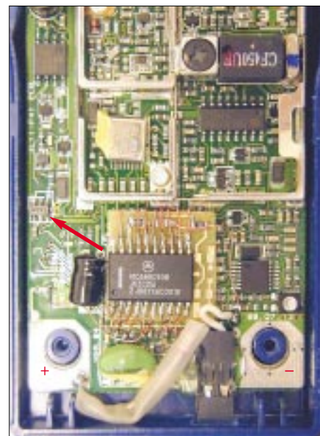
Bild 17: Das markierte Bauelement ist der 4-V-Spannungsstabilisator im TSOP-5-Gehäuse; in aller Regel überlebt er ein Verpolen der Betriebsspannung nicht.
