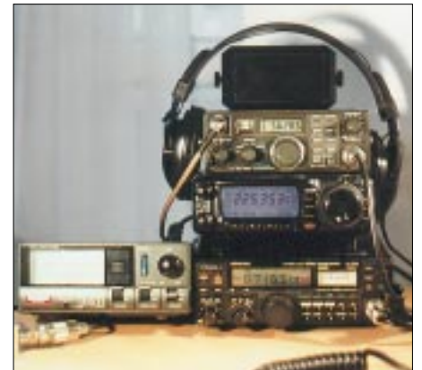
Bild 4: Blick ins Shack bei DG0OPK: Oben FT-790 für den 70-cm-Uplink, darunter der FT-100 für Downlink-Paßbandempfang, ganz unten TR-751 für Telemetrieempfang.
