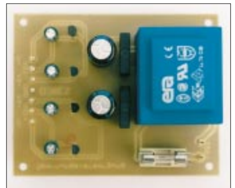
Bild 14: Die konstruktive Ausführung des in Bild 10 gezeigten Netzgerätes bietet keinerlei Besonderheiten. Insbesondere ist jedoch auf die maximale Strombelastbarkeit der Reglertypen aus der 78er Serie zu achten. Die Platinengröße wird vom Trafo bestimmt.
