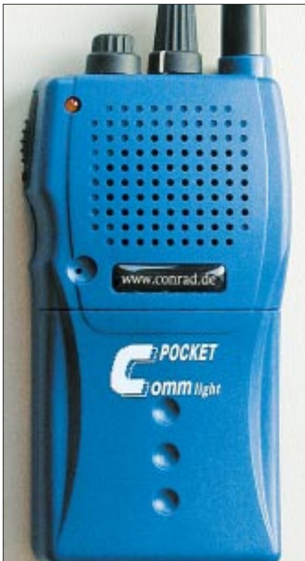
Bild 16: Pocket Comm – umgebaut und wieder betriebsbereit für 70-cm-Amateurfunk Fotos: OK2XDX
