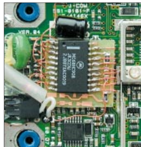
Bild 13: Detailausschnitt der fertig eingebauten Zusatzplatine
