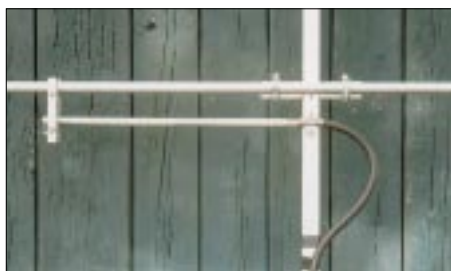
Bild 1: Gamma-Anpassung mittels Aluminiumrohr und Koaxialkabel
